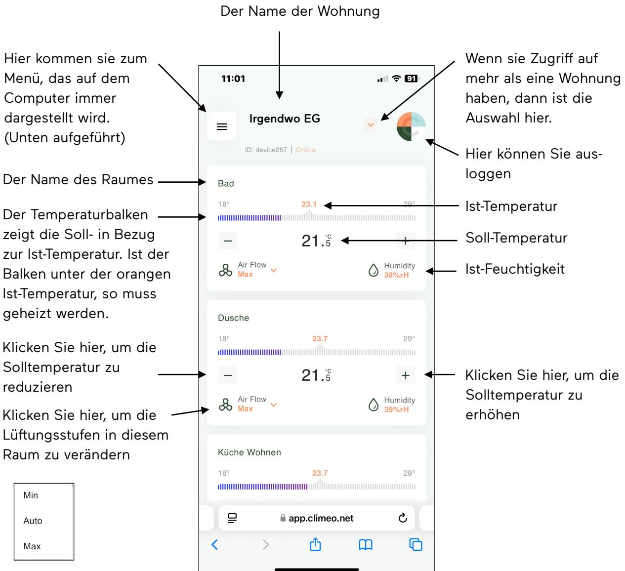
Die Einstellung Min und Max stellen den jeweiligen minimalen oder maximal eingestellten Luftvolumenstrom ein. Während die Auto-Einstellung je nach Situation (Feuchtigkeit, Luftqualität die Lüftung steuert.)
