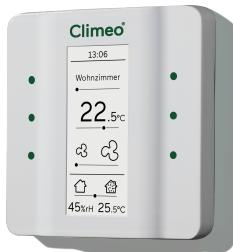
Der **RoomMaster** wird über eine Montageplatte Unterputz montiert. Er wird über eine 4-Draht ModBus Verbindung mit dem FlatMaster verbunden. Er bezieht seine Informationen vom FlatMaster und bedarf keiner Konfiguration.
