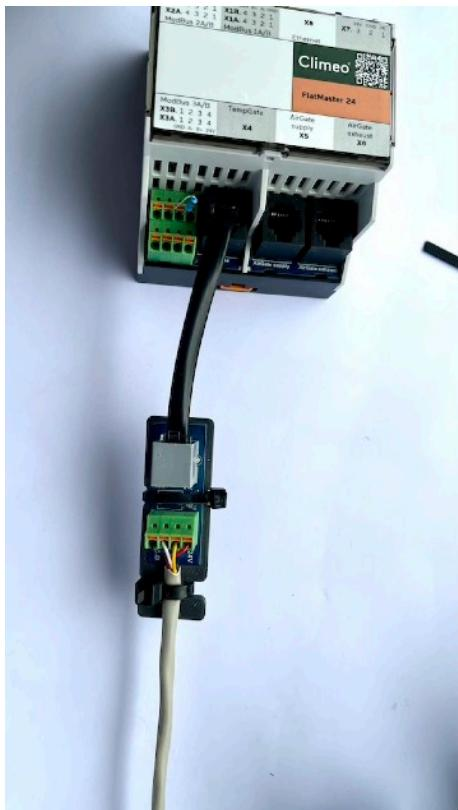
Die TempGates werden über einen RJ12-Klemmen-Adapter angeschlossen. Das Kabel sollte ein 2x2-adrig verdrilltes 0.8 mm<sup>2</sup> ModBuskabel sein.
