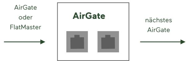
Dafür wird ein vorkonfektioniertes Kabel (RJ12) 30 cm mitgeliefert. Für abweichende Einbauten sind Kabelvarianten in den folgenden Längen lieferbar: 30, 50, 100 und 200 cm.
